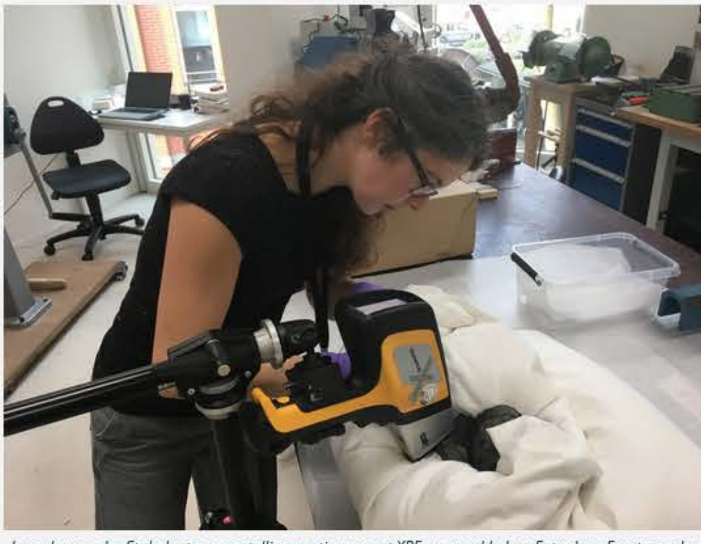
Janneke van der Stok doet samenstellingsmetingen met XRF op pronkbeker. Foto door Ernst van der Stok.
