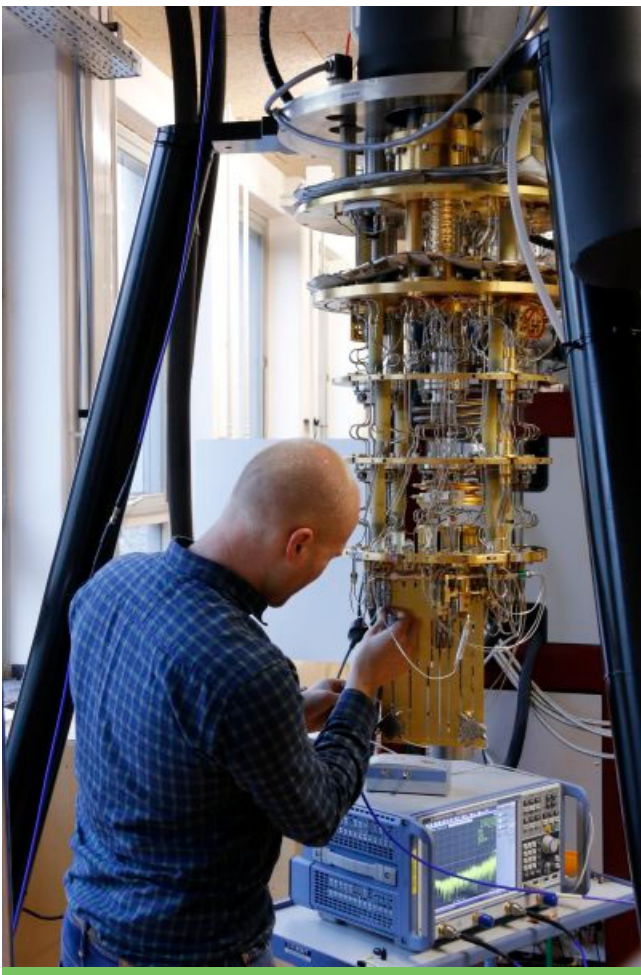
Niels Bultink aan het werk aan de binnenkant van een mengkoeler. De quantumprocessor wordt gemonteerd op de onderste plaat en vervolgens afgekoeld tot ongeveer 10 mK. Foto: Jacob de Sterke
