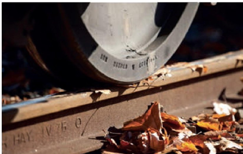
Bladeren op de rails veroorzaken zogeheten vierkante wielen
