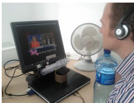
Figura 6. Sistema de prueba para integración olfativa y de vídeo. [9]
